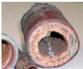
Жесткая вода представляет собой угрозу для котельных систем. Доказательством этой опасности является значительное снижение тепловой эффективности
