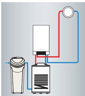
Пример нагревательной системы с газовым котлом и станцией водоподготовки
